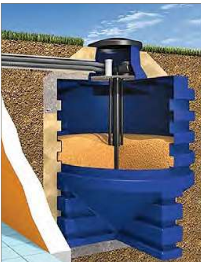
Abb. 17: Erdlager aus Kunststoff mit senkrechter Förderschnecke
